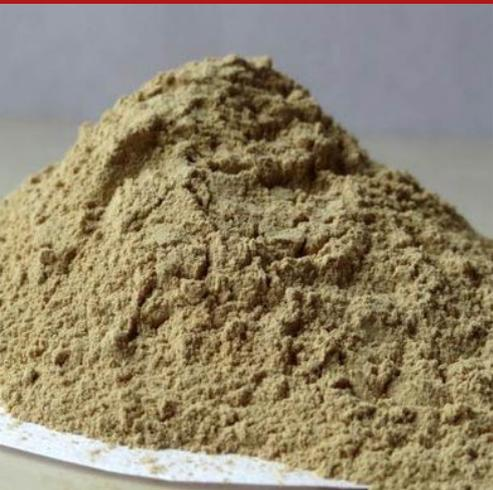
Claygrain è una bentonite sodica in polvere, sciolta, anidra, caratterizzata da un tenore di montmorillonite superiore al 90%, con basso yield-point (punto di snervamento). Il prodotto può essere utilizzato tal quale oppure miscelato con acqua, cemento e additivi, per ottenere miscele a diversi gradi di consistenza negli interventi di impermeabilizzazione e per svariate operazioni nel campo geotecnico.
