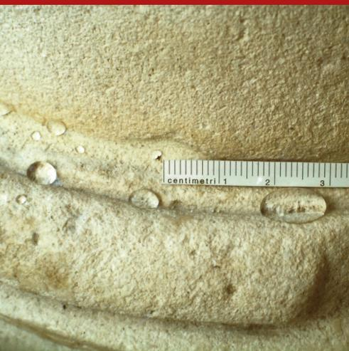
Prodotto consolidante idrorepellente siliconico in dispersione acquosa, formulato per l'idrofobizzazione, il trattamento antisalino ed il consolidamento di materiali minerali da costruzione assorbenti anche alcalini. Non determina variazioni cromatiche né alterazioni della traspirabilità. Materiale con bassissimo contenuto di VOC.
