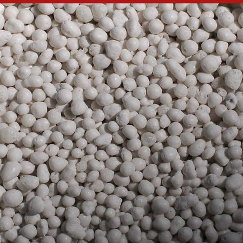
LIGHTGLASS EXP è un aggregato leggero di forma sferoidale che risponde alla normativa EN 13055-1 (Aggregati leggeri per calcestruzzo, malta e malta per iniezione). LIGHTGLASS EXP può essere vantaggiosamente impiegato nelle malte, nei rasanti, nei collanti e nelle boiacche d'iniezione, per migliorare l'isolamento termico, la traspirabilità e la lavorabilità degli impasti realizzati.
