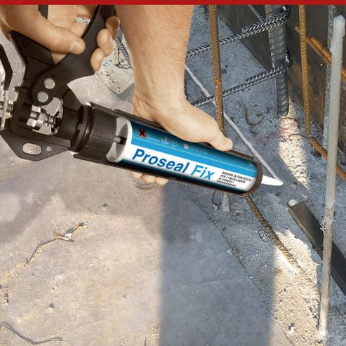
Adesivo polimerico a base di silani modificati, ad azione sigillante e permanentemente elastico, specifico per l'incollaggio di guarnizioni, giunti e cordoli, sia bentonitici (ad esempio Clayseal 25.20 e/o Clayseal 25.20 SW) che in gomma idroespansiva (ad esempio Sealgum 20.05), negli interventi di impermeabilizzazione degli elementi di ripresa di getto. L'adesivo è sostitutivo del più classico metodo di fissaggio di tali presidi ermetici, basato su chiodatura.
